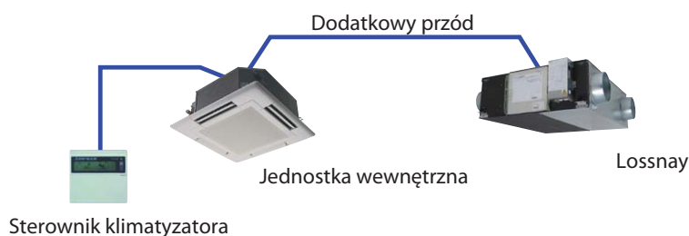
Rys. 5. Schemat ideowy podłączenia klimatyzatora z rekuperatorem Lossnay
